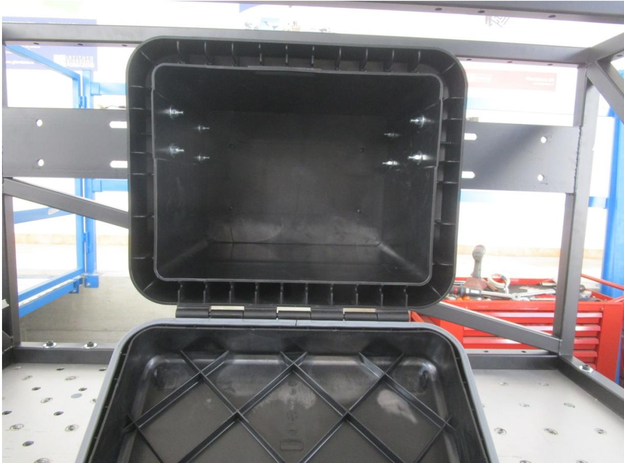
*Immagine 15 – asse longitudinale – cassetta al termine del test dopo la rimozione del carico applicato*
