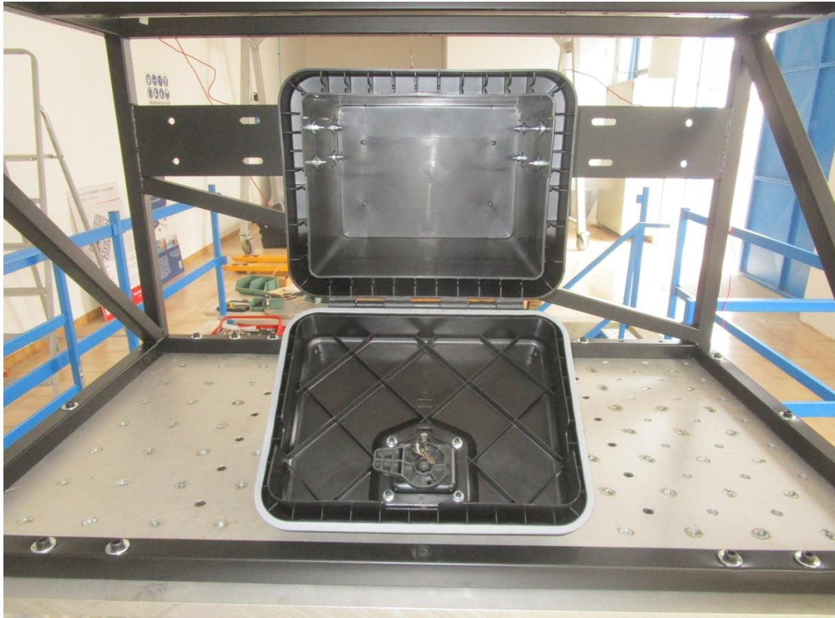
*Immagine 14 – asse verticale – cassetta al termine del test dopo la rimozione del carico applicato*
